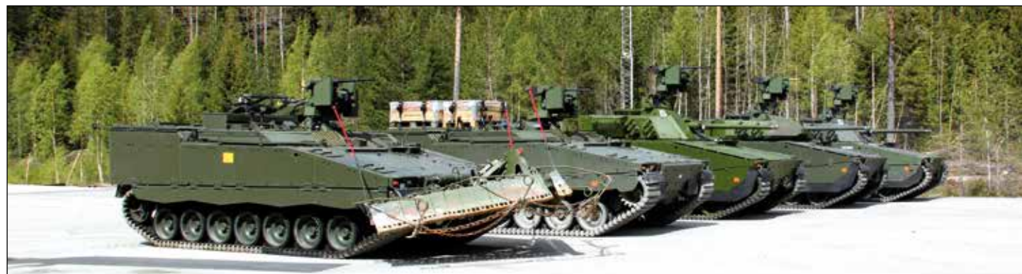
Ženíjní stormingeniørvogn (vpředu) s adminovacím pluhem v transportní poloze. Na střechnu korby víceúčelového multivognu (vzadu) lze upevnit rozměrné přepravní bedny či palety, které by bylo problematické vměstnat do interiéru obrněnce, což jej předurčuje mj. k plnění logistických úkolů.
