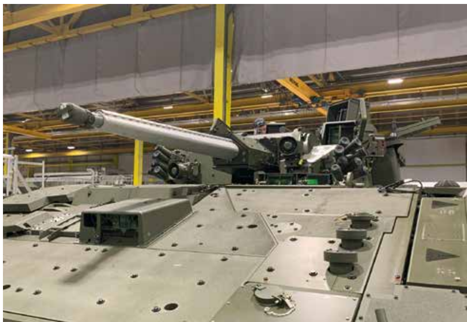
Všechna již vyrobená i v budoucnu vyráběná „věžová“ bojová vozidla Ajax mají obdržet na své kanony tepelnou ochranu hlavně (na snímku při zkouškách), která zlepší přesnost střelby a prodlouží životnost zbraně.
