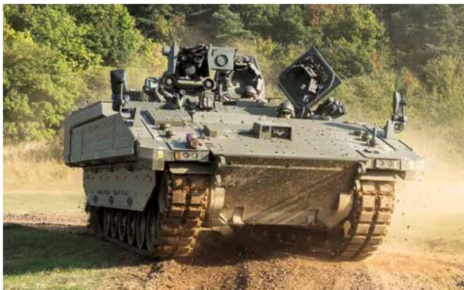
Obrněný transportér Ares během ukázek v září 2024 na polygonu Millbrook. Stejně jako ostatní bezvěžové varianty rodiny Ajax je i on vybaven dálkově ovládanou zbraňovou stanicí Kongsberg Protector.
