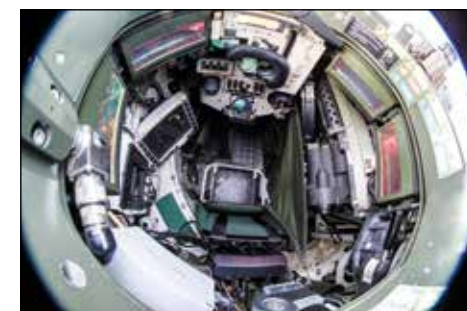
Pohled na stanoviště velitele vozidla CV9035NL, který může ve spolupráci se střelcem zaměřovat lafetovanou výzbroj na cíl pomocí systému řízení palby UTAAS (Universal Tank and Anti-Aircraft System)
