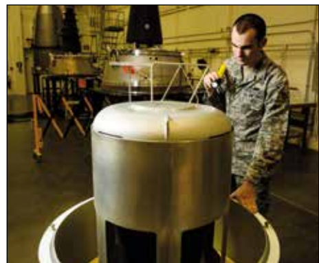
Technik z 676. zkušební letky kontroluje sériové číslo na návratovém modulu Mk.12A s nukleární hlavici W78, jež slouží jako bojová náplň mezikontinentálních balistických střel LGM-30G Minuteman III. Část starších W78 je nahrazována novějšími hlavici W87, dříve nesenými nyní již vyřazenými střelami LGM-118A Peacekeeper.
