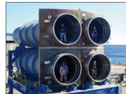
Součástí nových amerických ponorek Ohio Replacement Submarine i britských Successor bude čtyřnásobné odpalovací zařízení CMC (Common Missile Compartment). Každá Ohio Replacement Submarine ponese čtyři takovéto moduly.
