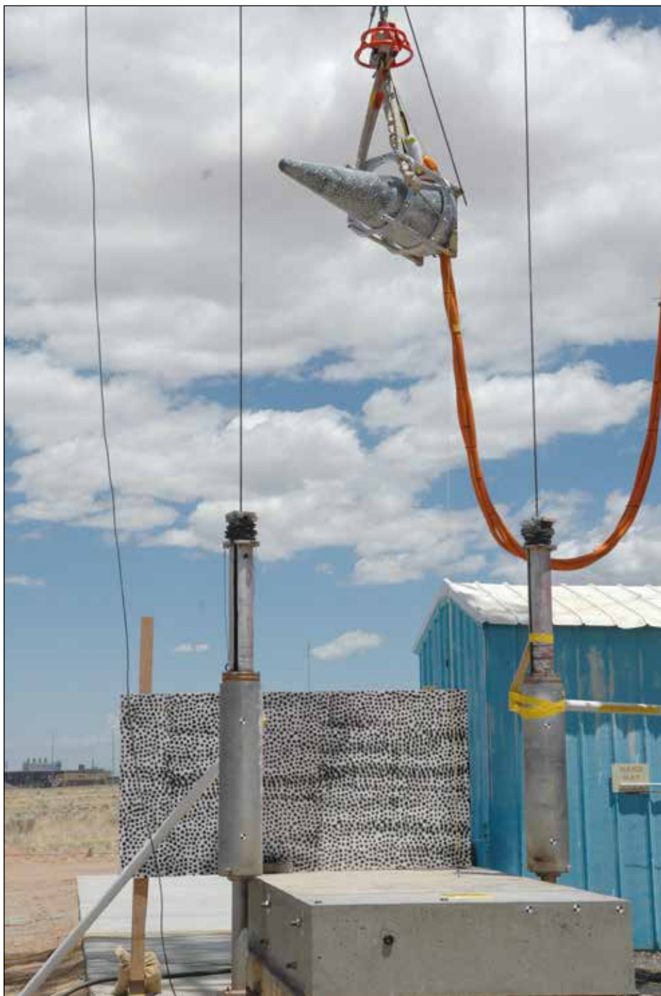
Pádová zkouška makety hlavice W88 Alt 370 provedená laboratoří Sandia v červenci loňského roku měla poskytnout data potřebná k modernizaci bezpečnostních mechanismů bránících samovolné explozi. Mohutnost výbuchu se u tohoto typu uvádí na 475 kt.
