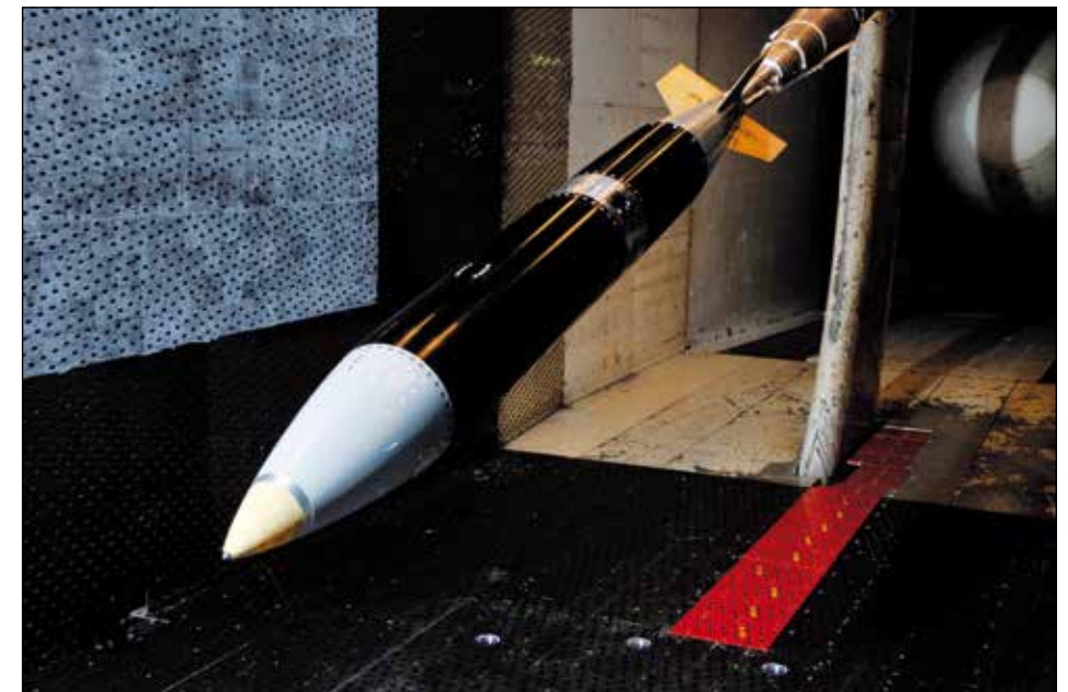
Maketa jaderné pumy B61-12 prošla v dubnu minulého roku zkouškami ve větrném tunelu výzkumného střediska AEDC, umístěného na letecké základně Arnold AFB v Tennessee. AEDC lze označit za jedno z největších a nejmodernějších leteckých zkušebních center ve světě, provozující dohromady 43 různých větrných tunelů, prostorů pro prověřování raketových a proudových pohonných jednotek, dopadových ploch ke zjišťování balistických vlastností a jiných specializovaných zařízení, která umožňují provádět přesná měření v simulovaných podmínkách letových hladin 0–480 km (čili i nízkých oběžných drah Země) a rychlostí až M = 20.
