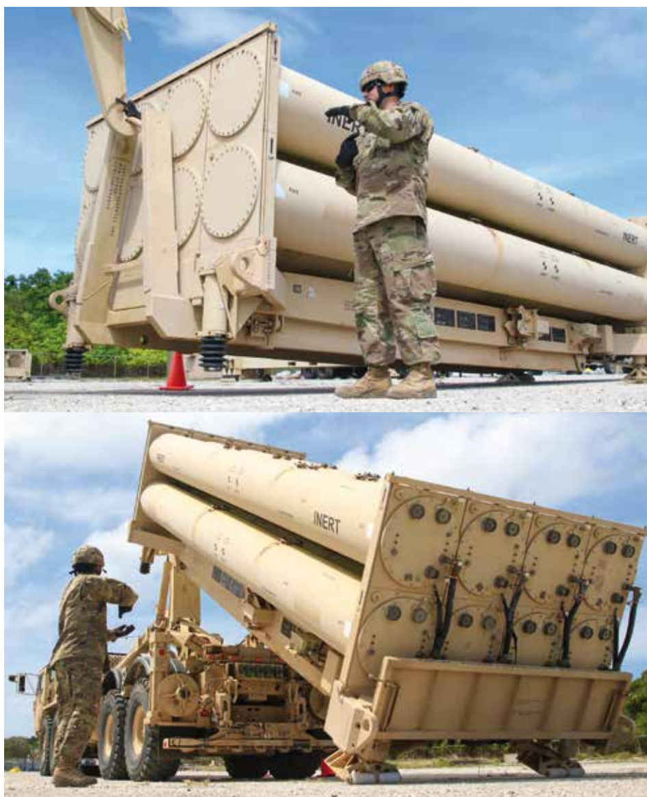
Osminásobní OZ se na přepravně-odpalovací vozidlo M1120 HEMTT LHS umísťuje pomocí integrovaného hákového nakladače.
