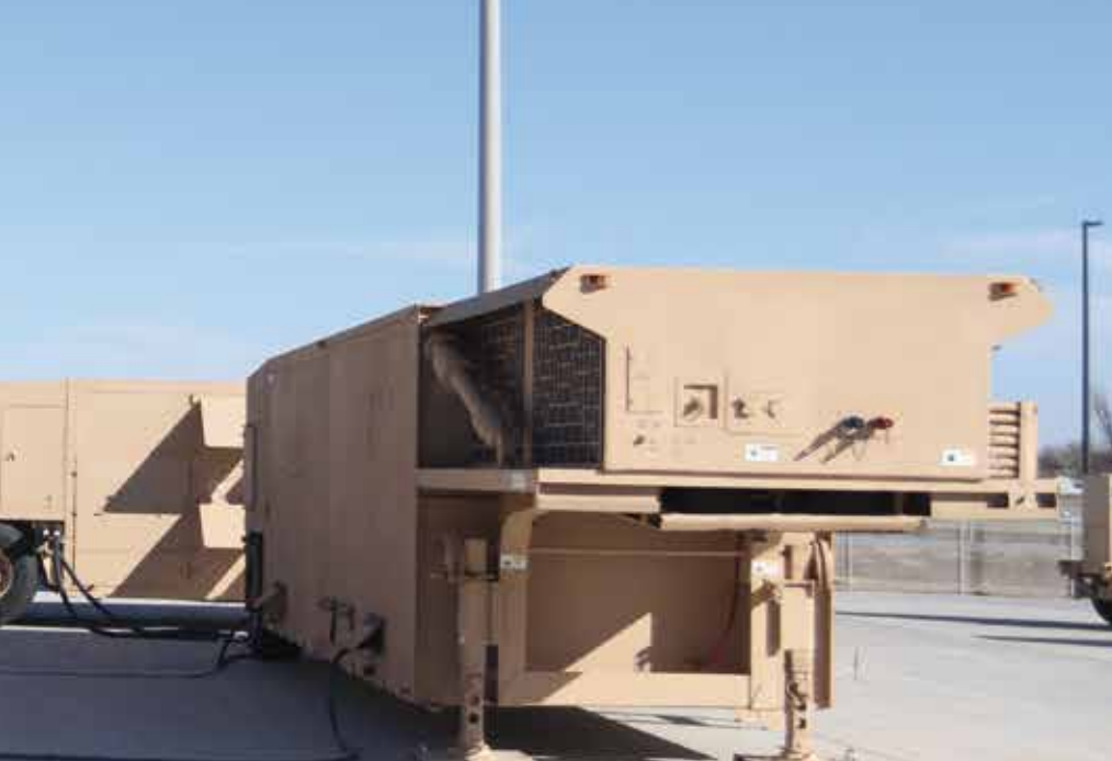
Celkový pohled na radar AN/TPY-2. Na snímku jsou anténní jednotka AEU (Antenna Equipment Unit; nachází se vlevo), elektronický modul EEU (Electronic Equipment Unit; napravo) a chladicí jednotka (Cooling Equipment Unit; v pozadí). Mimo záběr je generátor elektrické energie PPU (Prime Power Unit) o výkonu 1,3 MW a pracoviště operátorů.
