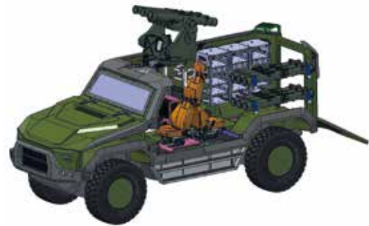
Počítačová kresba zachycující jedno z možných uspořádání vnitřního vybavení palebných vozidel. Definitivní podoba dnes pochopitelně k dispozici ještě být nemůže.
