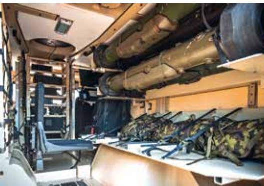
Interiér vozidla MARS na výstavě IDET 2025. Na pravé straně jsou válcové přepravné/vypouštěcí kontejnery pro PLŘS. Definitivní provedení uložení raket a dalšího vybavení si ale určí uživatel. Titulní snímek zachycuje palebné vozidlo kompletu MSHORAD.
