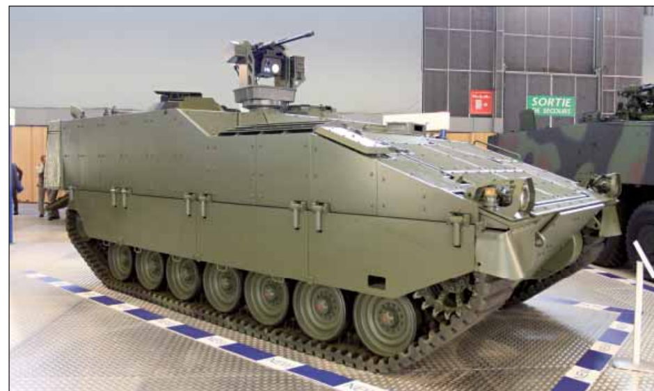
Nový ASCOD 35t s instalovanou bezosádkovou zbraňovou stanicí Lemur, předvedený na letošní výstavě Eurosatory
