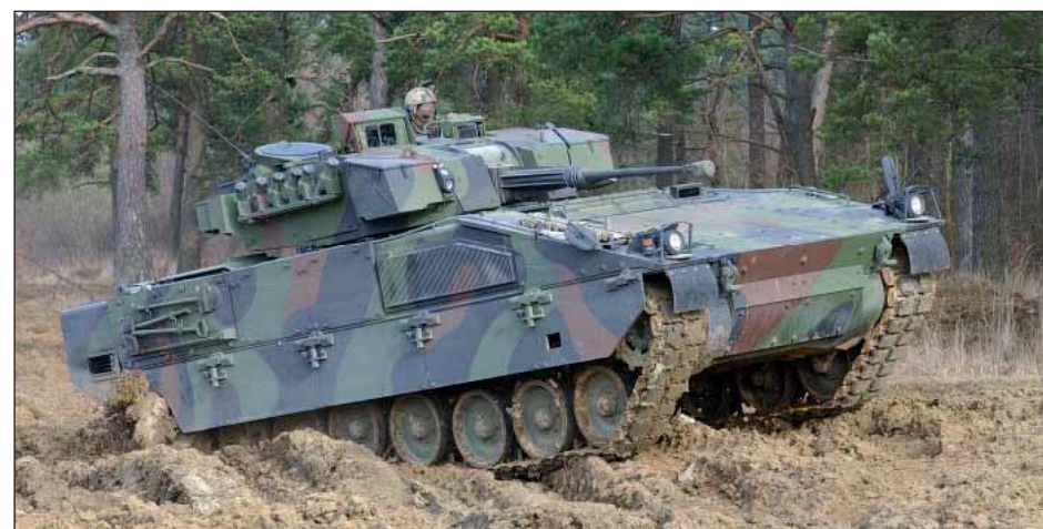
Původní ASCOD v rakouské modifikaci Ulan, vyzbrojený věží s 30mm automatickým kanonem MK30-2 a spřaženým kulometem MG3 ráže 7,62mm
