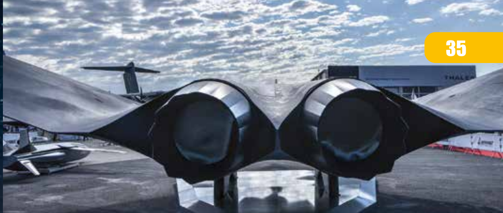
Motory pro NGF od společností Safran a MTU Aero Engines budou mít schopnost vektorování tahu.
