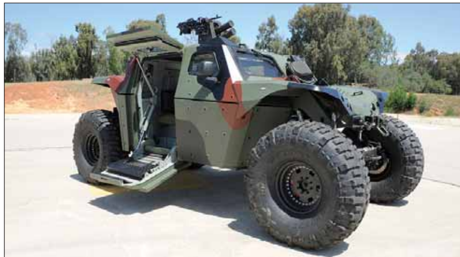
Pro vstup do vozidla slouží čtveřice dvoudílných hydraulicky otevíraných dveří
