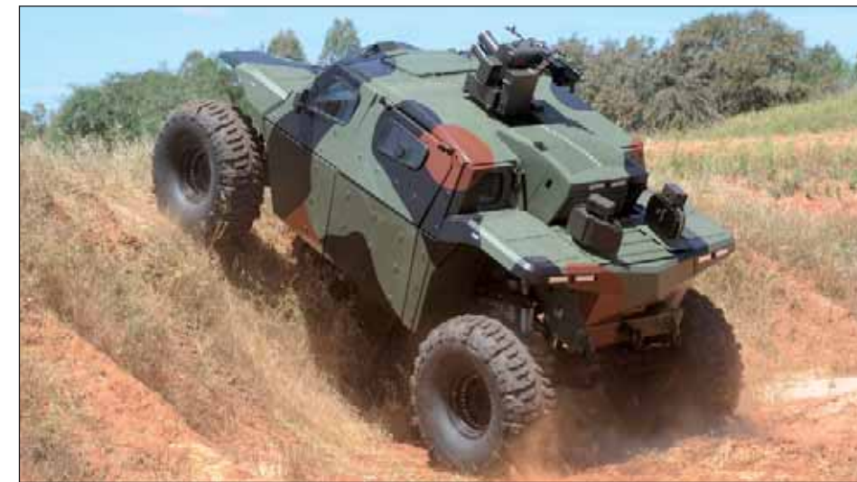
Výzbroj Combat Guardu je tvořena systémem aktivní ochrany Bright Arrow APS kombinovaným se stabilizovanou bezosádkovou zbraňovou stanicí
