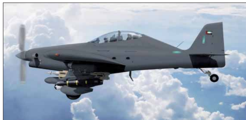
Možná podoba budoucího modernizovaného Archangelu, který by v zájmu dosažení vyšší rychlosti měl mít mimo jiné nový překryt pilotní kabiny, zakrytované podvozkové nohy, novou vrtuli a upravenou aerodynamiku křídla
