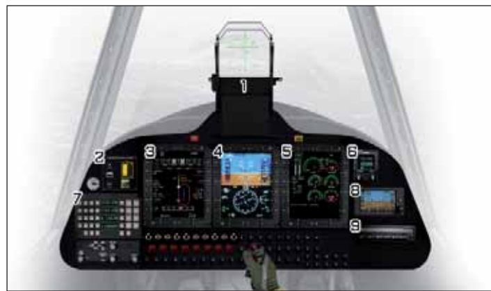
Přední a zadní kokpit letounu Archangel. Avionika je postavena na systému Esterline CMC Cockpit 4000.
