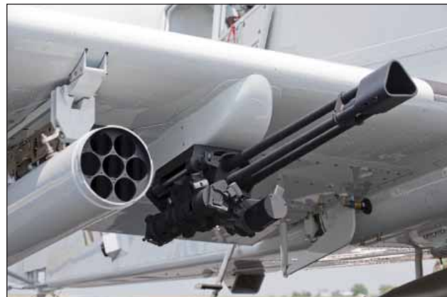
Raketový blok ráže 70 mm a kulomet GAU-19/A ráže 12,7 mm podvěšené na letounu AT-802U
