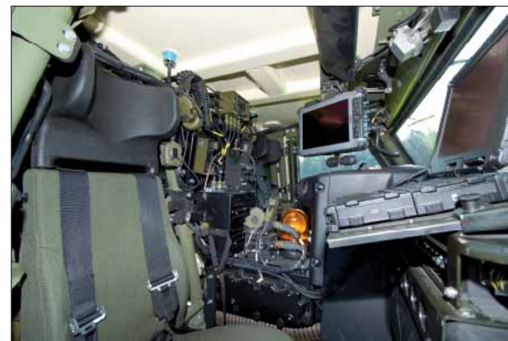
Pohled na pracoviště velitele s dobře patrným terminálem bojového informačního systému BVIS/DěL na skloněné posuvné konzole u stropu a se sklopným/otočným PC tabletem zobrazovacího systému
