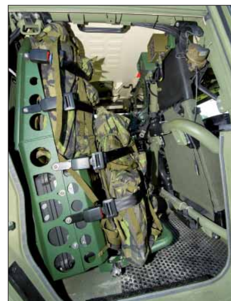
Na místě pravého zadního sedadla je uložena přenosná souprava SNPz, umístěná ve dvou batohách
