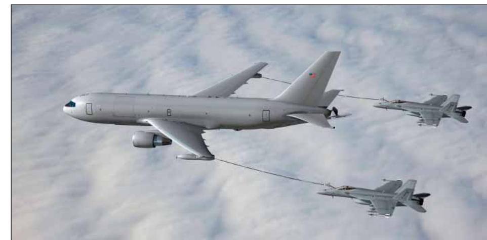
Díky podkřídlovým jednotkám WARP bude moci KC-46A poskytovat palivo i metodou Probe and Drogue
