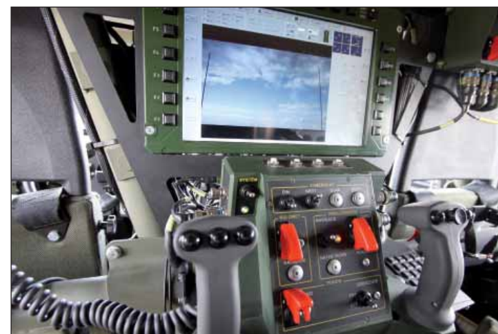
Detailní záběr na integrovanou řídicí jednotku, multifunkční displej a dvojici joysticků operátora
