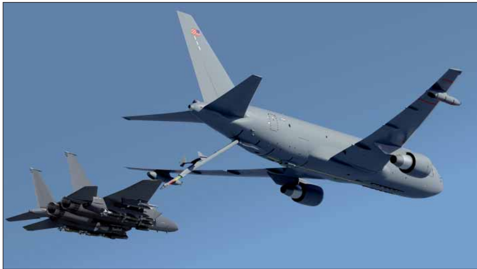
Kapacita tankovacího nástavce KC-46A bude více než 4 500 litrů paliva za minutu
