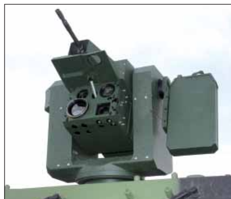
Dálkově ovládaná stanice ZSRD07-Pz. Box na pravé straně obsahuje zásobu 500 kusů munice
