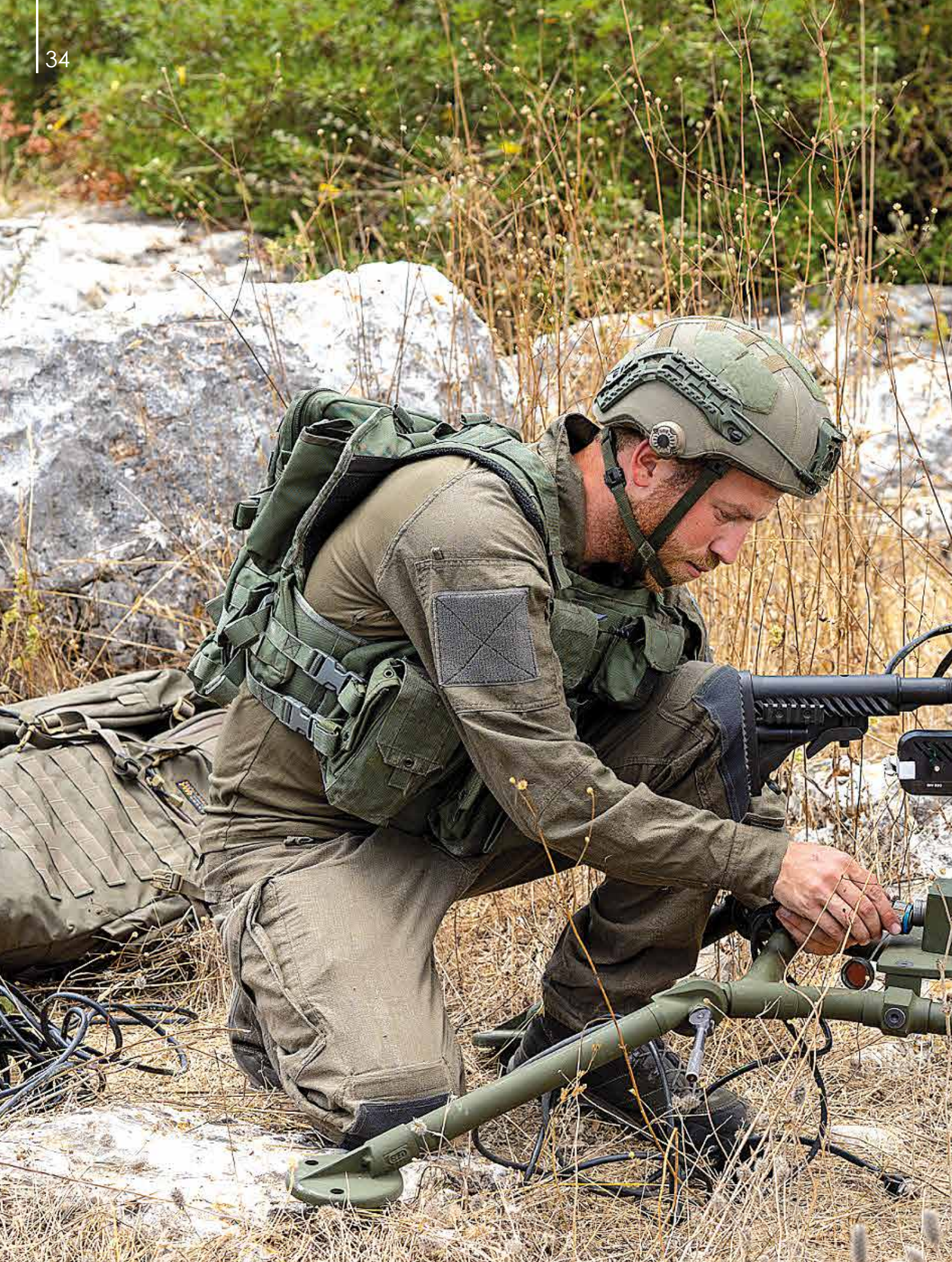
Operátor připravuje zbraňovou stanici Smash Hopper k použití. Na snímku dobře vyniká její subtilnost – celý systém, včetně systému řízení palby, zdroje napájení a řídicí konzole, váží do 25 kg.
