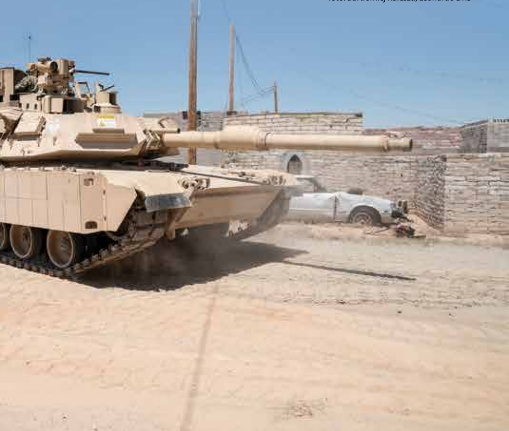
Abrams během zkušebního programu v USA. Boky korby jsou opatřeny bloky dynamické ochrany ARAT-1.
