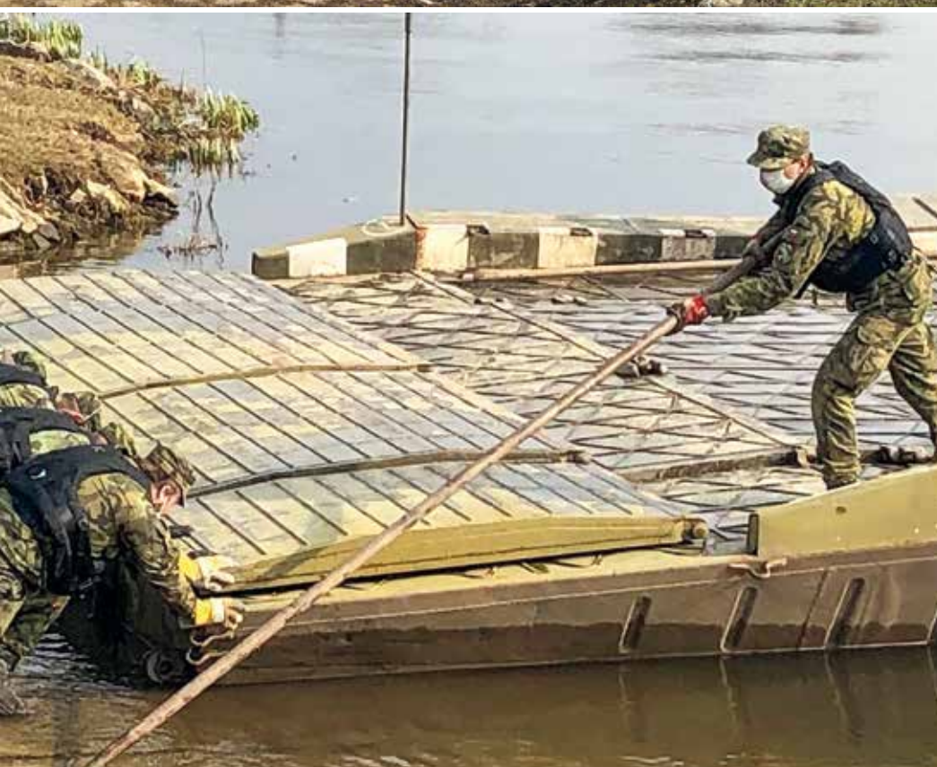
Odrážení soulodí na vodu
