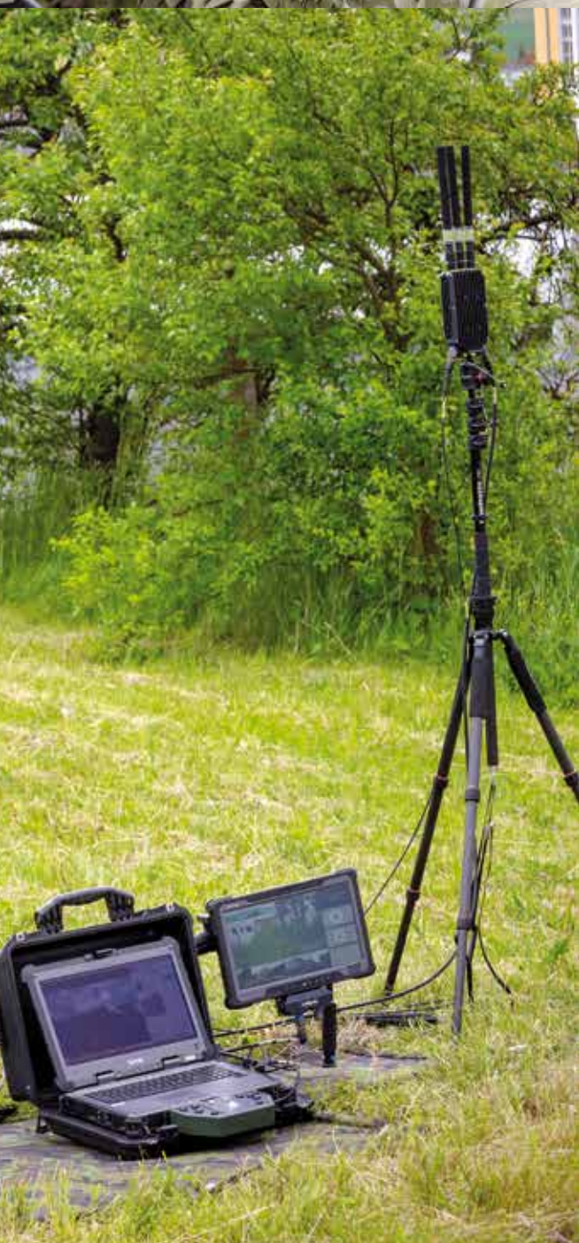
Detail integrovaného pozorovacího systému IPoS sloužícího ke sledování blízkého okolí a k detekci hluku. Skládá se z pozorovacího a akustického subsystému.
