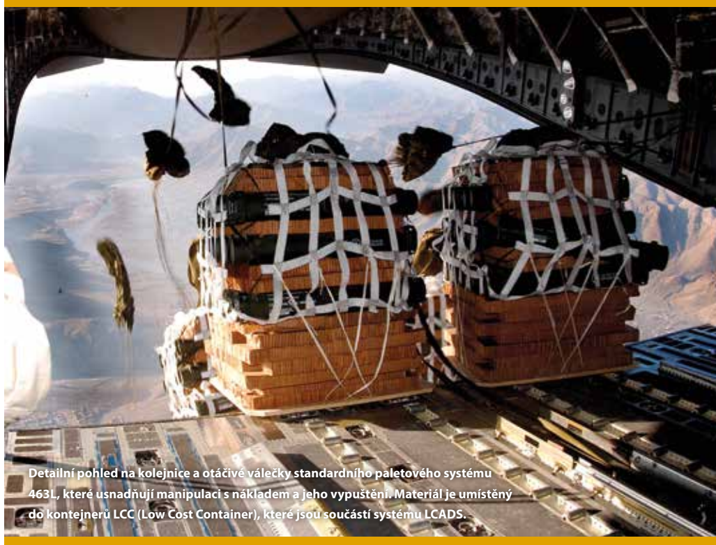
Často používaným způsobem balení materiálu je souprava CDS, jež sestává z textilního kontejneru A-22 a překližkové palety. Pro manipulaci a ukotvení v nákladovém prostoru se CDS zasouvá do kolejnic paletového systému 463L.
