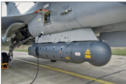
Kontejner typu Litening III v podvěsu pod letounem JAS-39 Gripen
