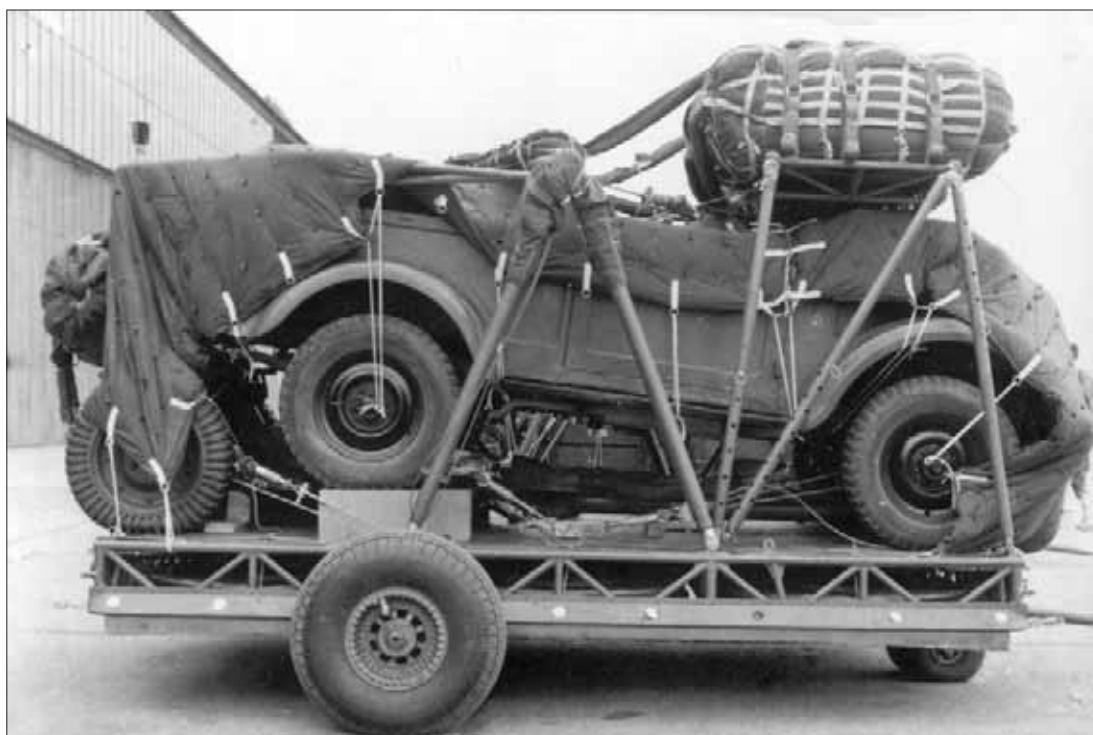
... dopravovat také pomocí shozu. Padáková plošina P-127 sovětské výroby s automobilem GAZ-69 a bezzákluzovým kanonem vz. 59.
