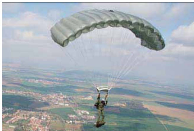
Seskok s výstrojí a výzbrojí na padáku SOV (Special Operation Vector) pro seskoky typu HALO (High Altitude - Low Opening) - HAHO (High Altitude - High Opening).
