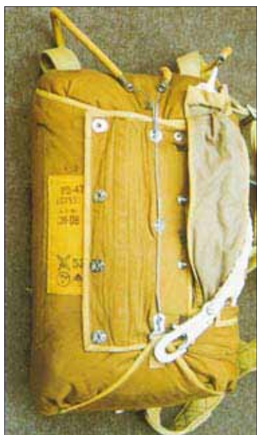
Padák PD-47 měl jednoduchý mechanismus otevírání využívající výtažné lano v letounu.
