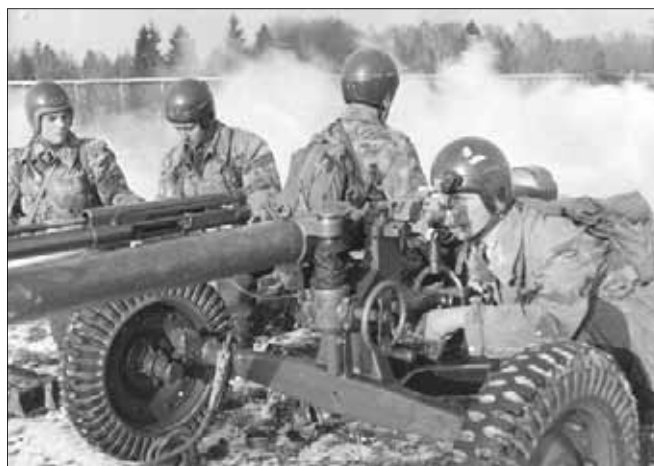
22. výsadkový protitankový oddíl měl tři baterie protitankových bezzákluzových 82mm kanonů vz. 59.
