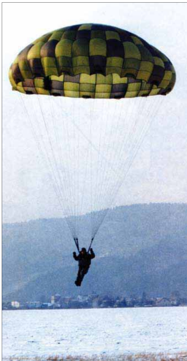
V osmdesátých letech byl pro jednotky hloubkového průzkumu zaváděn padák OVP-80 s novými konstrukčními prvky i způsobem řízení. Byl doplněn záložním padákem ZVP-80.
