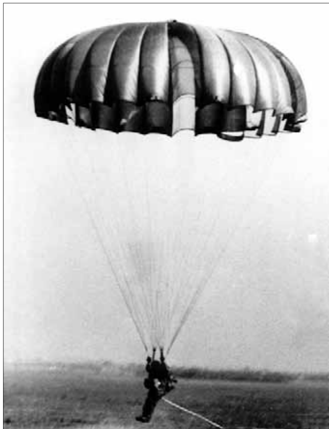
Padák OVP-68 se vyznačoval dobrou říditelností a širokým záběrem možného použití a byl určen především pro jednotky hloubkového průzkumu. Stal se prvním padákem, který nepočítal s využitím pro seskoky z upoutaných balonů.
