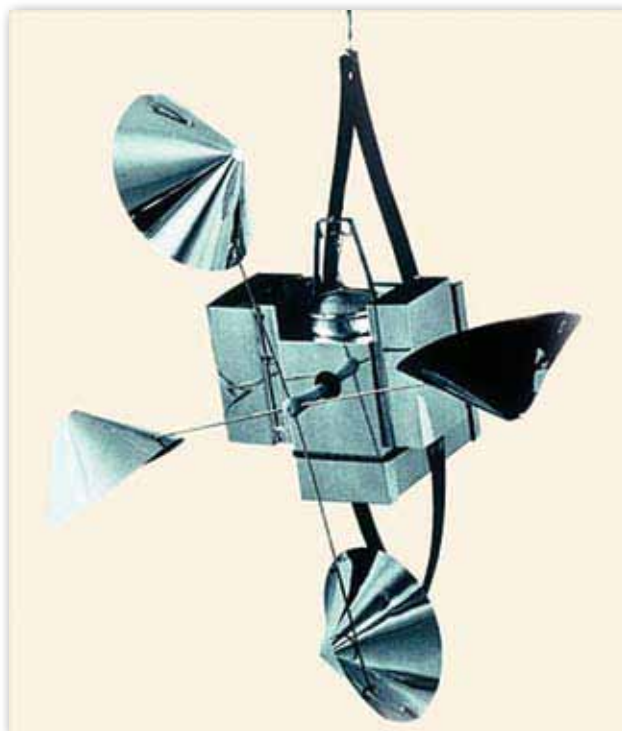
První sériově vyráběná radiosonda Vaisala RS-11 z roku 1936
