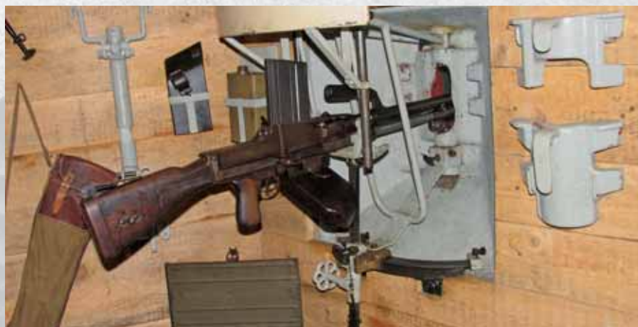
Pevnostní lafeta pro lehký kulomet vz. 26 v objektu lehkého opevnění vz. 37.
