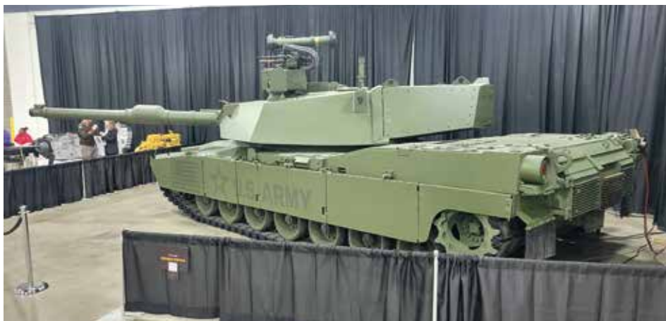
V zadní části věže byl přidán modul, pravděpodobně pro umístění automatického nabíjecího zařízení pro 120mm kanon. Tím by se počet členů osádky snížil ze čtyř na tři.
