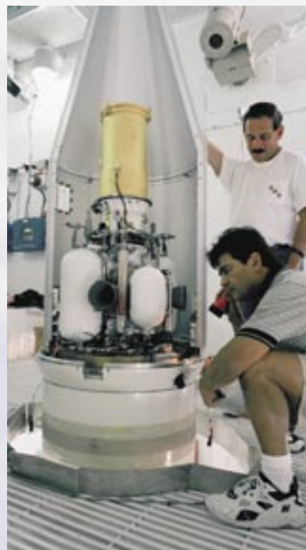
Hlavice protiraket s akčním prostředkem EKV, který ničí balistické rakety protivníka účinně svojí kinetickou energií.
